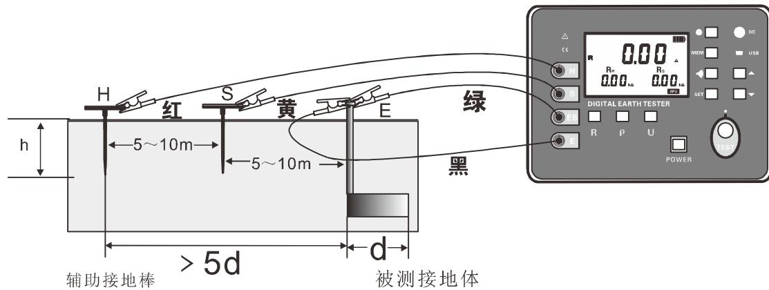
对于多点独立接地系统或大地网接地系统，用户自行选用更长的测试线即可，电极间距大于被测试地网最大对角线长的 5 倍即可。如下图：
