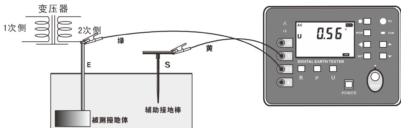
商用接地体对地电压测试
