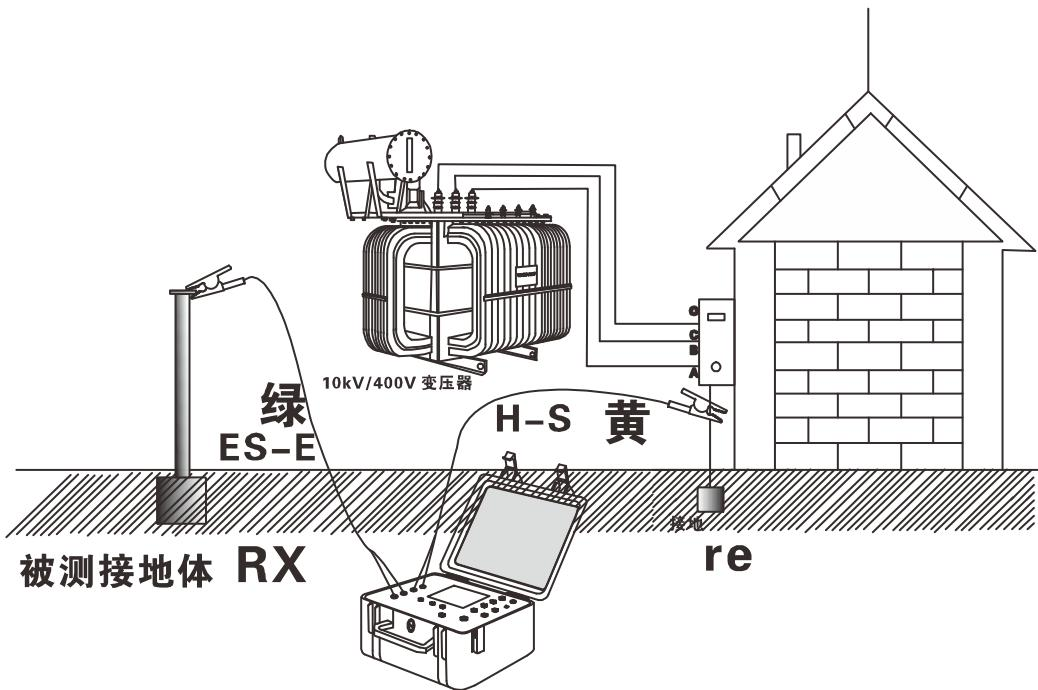
二线简易法测量接地电阻，其仪表读数为被测接地体的接地电阻值与商用接地体的接地电阻值之和，即：
