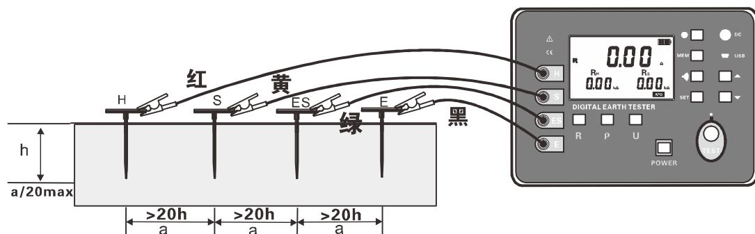
辅助接地棒的间距设置：连接好测试线后，开机按功能按键 **ρ**，进入土壤电阻率测试模式，长按“**SET**”键（超过3秒）进入辅助接地棒的间距设置，短按“**●**”键移动光标，按“**▲**”或“**▼**”键改变当前数字大小（**a**值范围：1m~100m），再长按“**SET**”键（超过3秒）保存设定的**a**值，并返回土壤电阻率测试模式。
