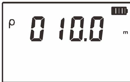
设定完**a**值后，在土壤电阻率测试模式下，按“**TEST**”键开始测试，并倒计数显示测试进度，完成测试后显示稳定的土壤电阻率值。
