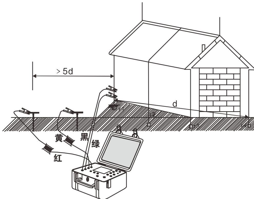
$$R = r_1 // r_2 // r_3 // r_4 // r_5 // r_6 // \dots // r_n \quad (r_1 \dots r_n \text{ 都是独立接地点})$$
